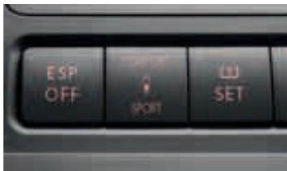
Die Modi „Sport“ und „Comfort“ werden über eine Taste vor dem Schalthebel angewählt.
